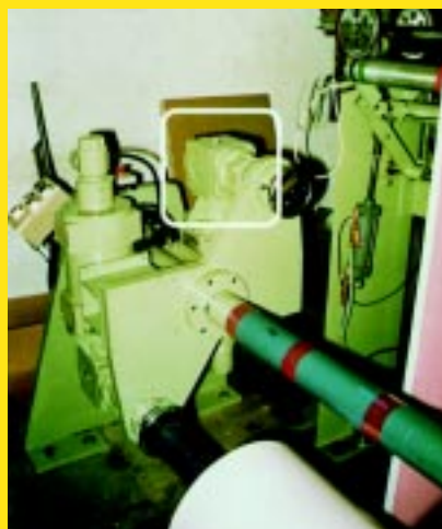
伞齿齿轮箱在印刷行业的卷取装置上的应用
