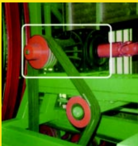
大伞齿在滑雪缆车的卷扬索缆上的应用
